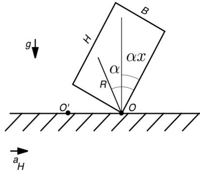
Figura 1: Modelo de oscilações sísmicas no bloco.
